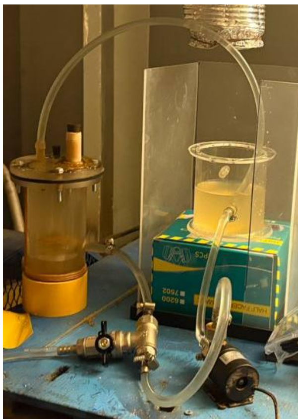
Рисунок 2. Процесс выщелачивания песчаных пород в массообменном аппарате
